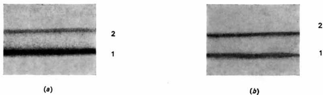
Fig. 7. Pinceaux obtenus après le second cristal dans la direction du faisceau réfléchi. (a) \nabla_r T = 0^\circ \text{cm}^{-1} ; (b) \nabla_r T = 35^\circ \text{cm}^{-1} 1: champ 1; 2: champ 2.
